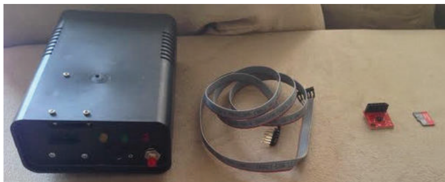
Figura 22: Caixa preta, cabo, acelerômetro e sd card.
